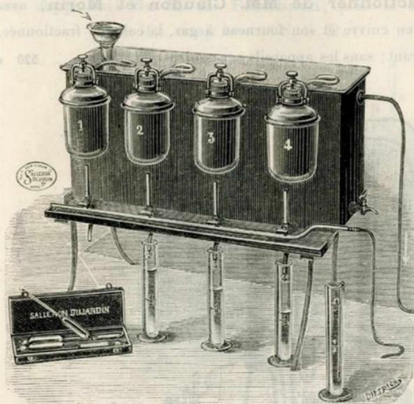
1904. **Alambic Salleron**, à quatre chaudières disposées en batteries, pour distillations multiples, complet avec alcoomètres, éprouvettes et chaudières de l'alambic.
